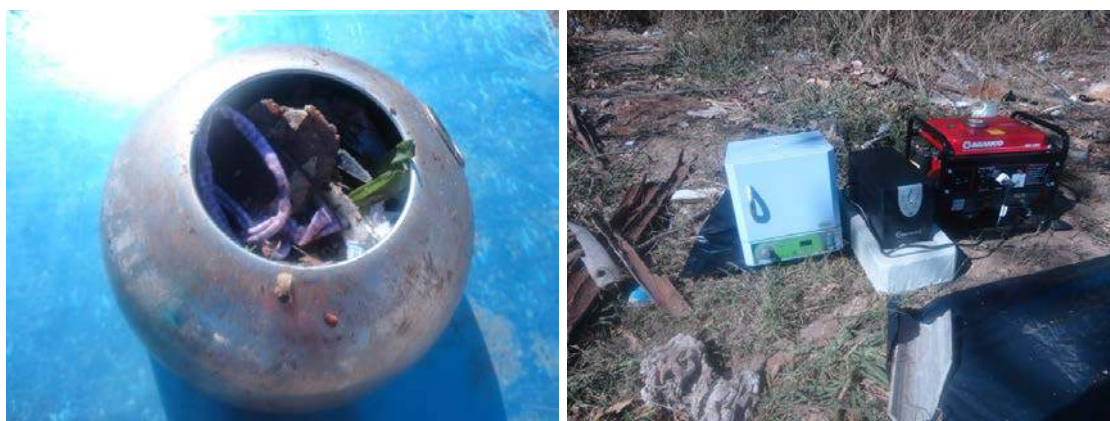
Figura 8 - Amostra de 2L de resíduos sendo pesada e posteriormente inserida em estufa que aquecerá até 105^\circ\text{C} .
