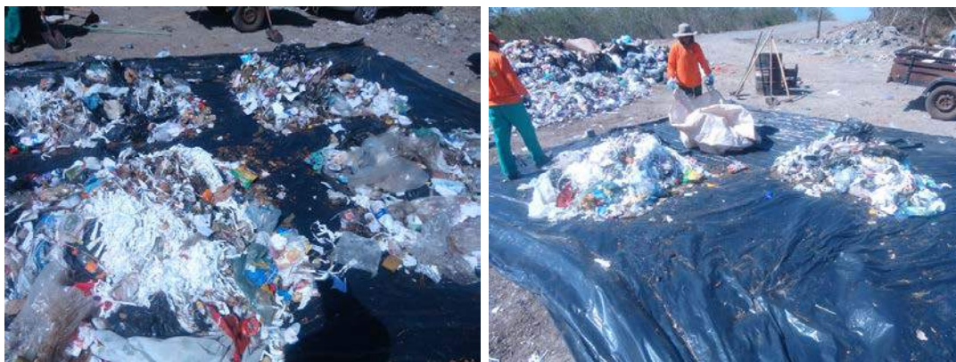
Figura 7 – Quarteamento, seleção e armazenamento de amostragem homogeneizada.
