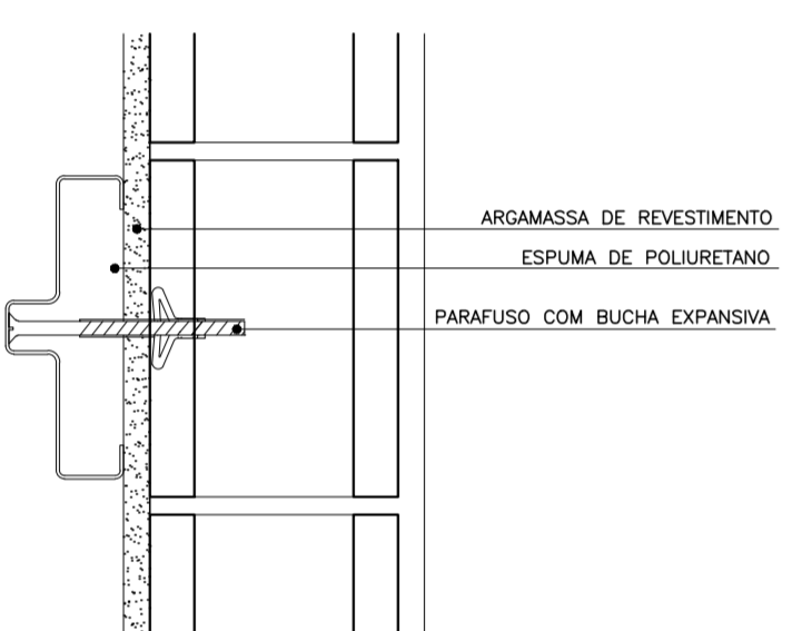
DETALHE FIXAÇÃO BATENTE METÁLICO ESCALA 1:5
