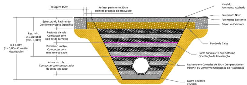
Corte e Reaterro de Valas (h ≤ 3,00m) - Vias com Pavimento Existente
